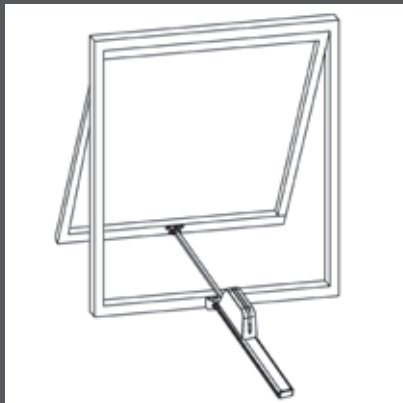
Installation sur châssis projetant
